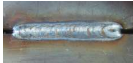
Рис. 2. Шов, выполненный универсальным сварочным инвертором Mekle High Pulse 550 в смеси защитного газа (углекислота + аргон 20/80) с помощью проволоки 1 мм СВ08Г2С.
